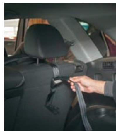
Pour ce siège, attachez toujours l'attache supérieure au point d'ancrage.
